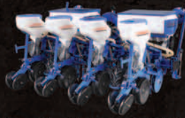
Diskli Tip Pnömatik Hassas Ekim Makinası Hidrolik & Manuel Kaydırmalı Disc Type Pneumatic Precision Drills Hydraulic & Manual Shifted
